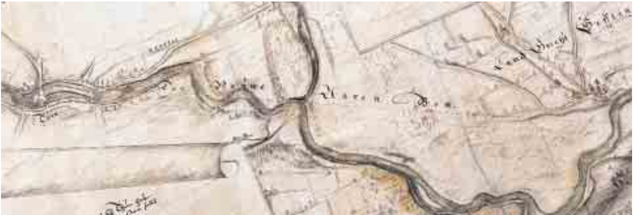
Fig. 127 Plan de Thoune et du cours de l'Aar en aval de la ville, avec l'embouchure de la Kander et de la Zulg. En traitillé: le nouveau lit de l'Aar prévu par S. Bodmer en 1710. Sens de l'écoulement: de gauche à droite.
