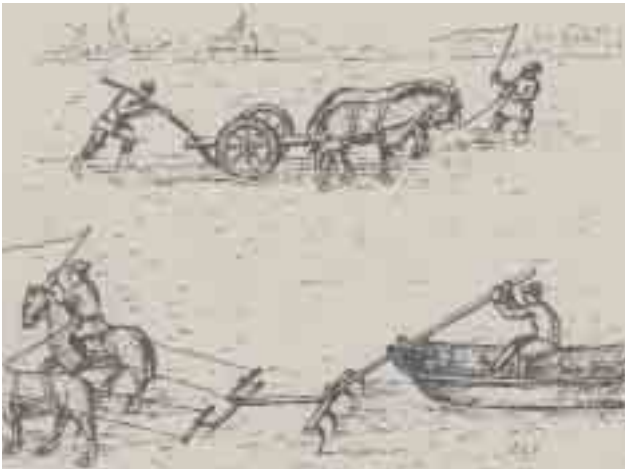
Fig. 44 Engins pour ameublir le fond du lit afin que le sable puisse être entraîné par le courant. Dessin d'après J. Leupold, 1724.
