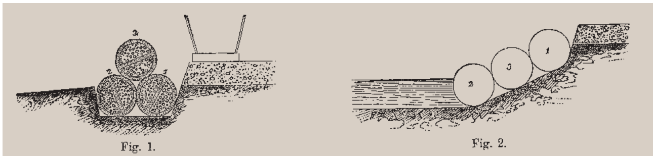
Fig. 136 Stabilisation des berges de la Broye au moyen de fascines à noyau, selon le système de Gumpfenberg (ingénieur du Lech, en Bavière), vers 1865.
