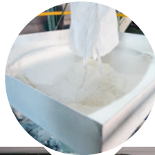
Tri des matériaux composites avec adjonction de l'agent inerte
